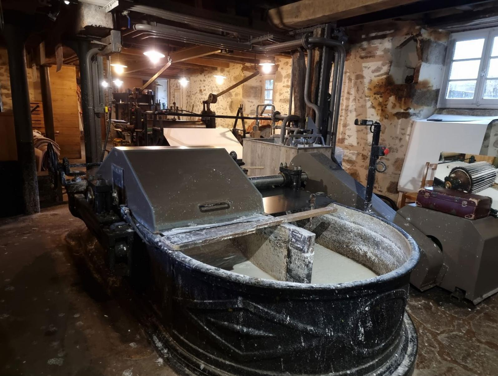
Fabricación de la pasta de papel con distintos elementos naturales de alto contenido en fibra y celulosa.
